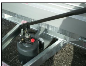
Bild 1.1: metallbehållare Version: handpump
