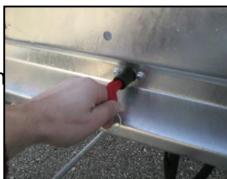
Bild 8: huvudströmbrytare i OFF-läge
