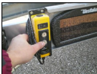
Bild 7: tryck på knappen för att sänka flaket
