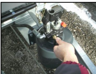
Kuva 3.1: laskuventtiili Ver.: käsipumppu
