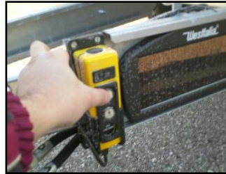
Kuva 6: paina painiketta lavan nostamiseksi
