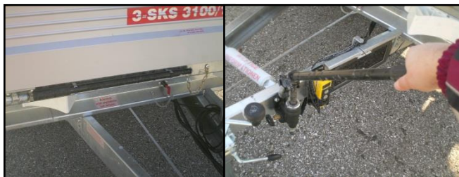
Bild 4: spak och handpump
