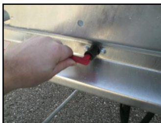
Bild 5: huvudströmbrytare i ON-läge
