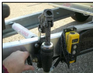
Kuva 3.1: laskuventtiili Ver.: käsipumppu
